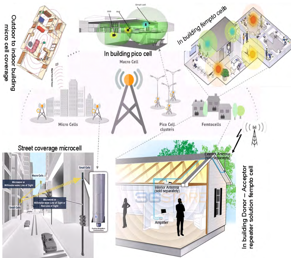
Σχήμα 5.13: Κυτταρική διάσπαση – Inter-Radio Access Technology ετερογενής ράδιο-κάλυψη, περιβάλλον LTE/WCDMA/GSM macro/micro/pico/fempto cell
