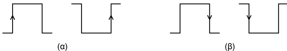
Σχήμα 6.17. Θετικές (α) και αρνητικές (β) ακμές παλμών ωρολογίου
